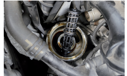
Resim 3: Yağ filtresinin karşı basıncı olmadığına, dikey boru flanştan dışarı fırlayabilir
