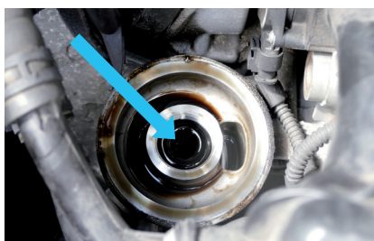
Εικόνα 2: Άποψη από πάνω της φλάντζας φίλτρου λαδιού και του ενσωματωμένου σωλήνα ανύψωσης (βέλος)
