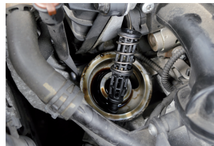
Abbildung 3: Ohne den Gegendruck des Ölfilters kann das Standrohr aus dem Flansch herausspringen
