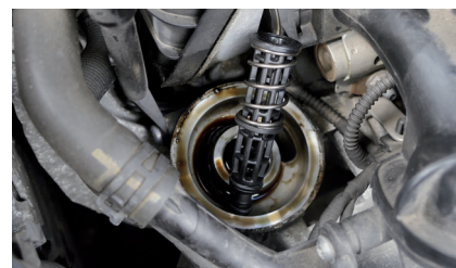
Иллюстрация 3: без противодействия, оказываемого масляным фильтром, трубка масляного фильтра может выскочить из фланца
